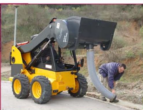
▲ Sistema de vaciado Discharging system
